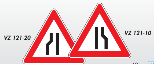
Einseitig (links)verengte/einseitig (rechts)verengte Fahrbahn
